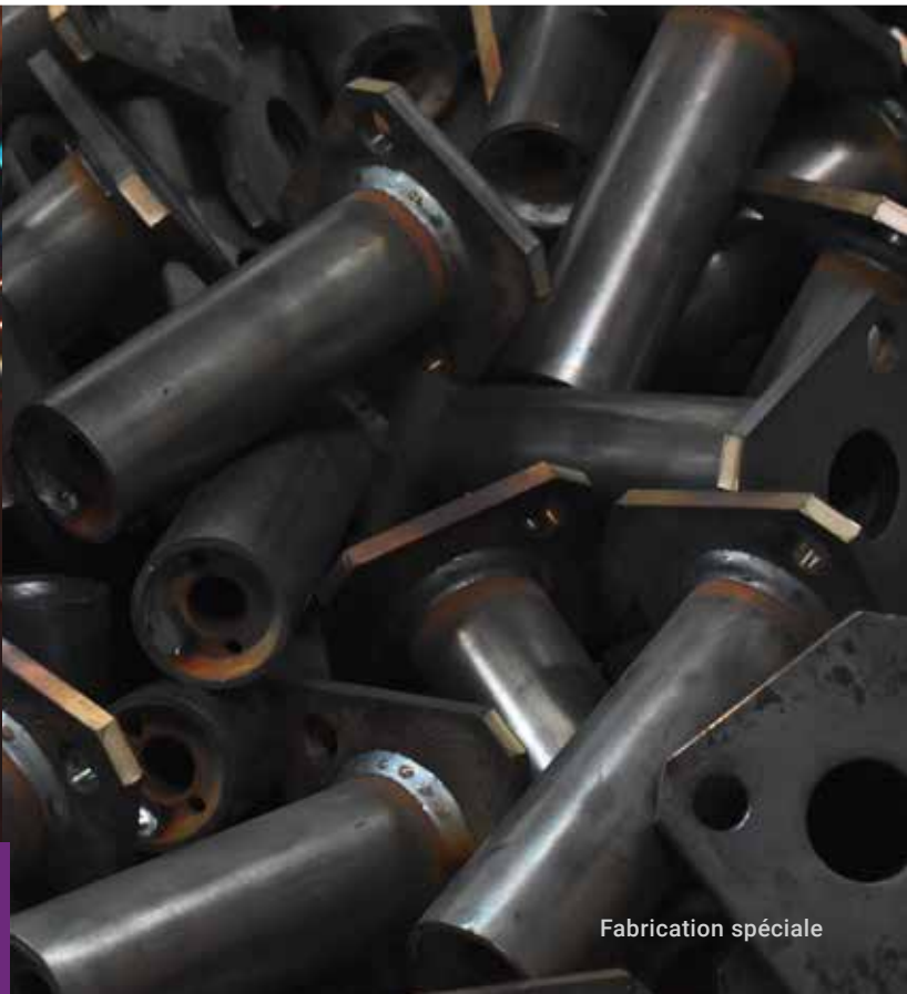
▲ Soudure sur platines de pieds de poteaux spéciales
