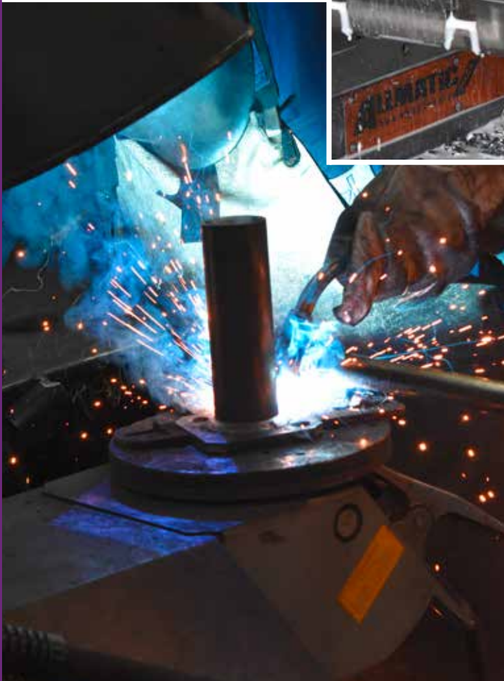
▲ Soudure sur platines de pieds de poteaux spéciales
